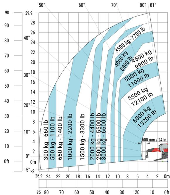
**Maschine auf abgesenkten Stabilisatoren mit Winde 6000 kgMaschine auf abgesenkten Stabilisatoren mit Galgen 6000 kg (Metric)**
