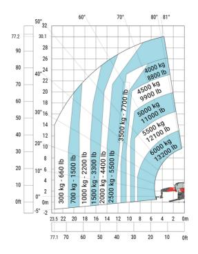
Máquina sobre estabilizadores rebajados con plumín de 2000 kg con cabrestante (sistema métrico)
