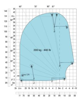
Rotación sobre estabilizadores bajados, con 3D negativa Rotación sobre estabilizadores bajados, con 3D positiva/negativa
