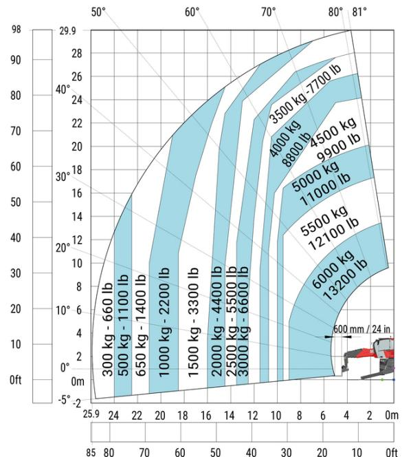
Macchina su stabilizzatori abbassati con verricello 6000 kg Macchina su stabilizzatori abbassati con braccetto da 6000
