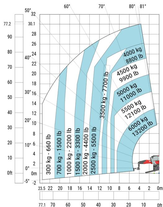
Macchina su stabilizzatori abbassati con braccetto da 2000 kg con argano (metrico)
