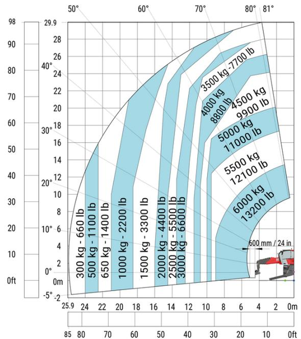
Macchina su stabilizzatori abbassati con verricello 6000 kg Macchina su stabilizzatori abbassati con braccetto da 6000 kg (metrico)
