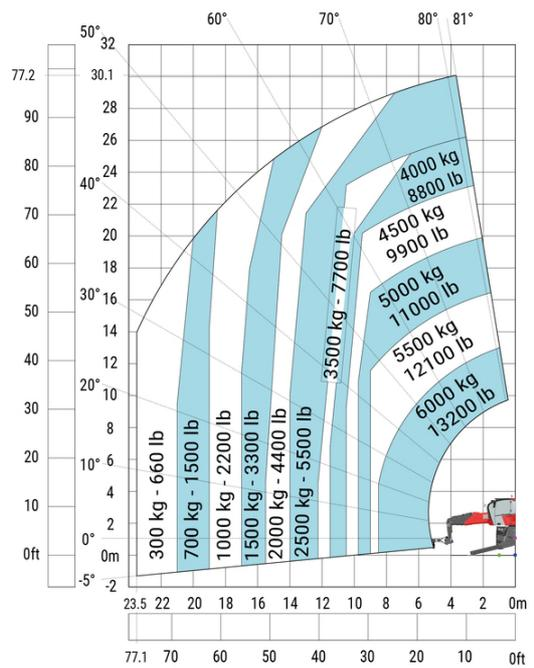
Macchina su stabilizzatori abbassati con braccetto da 2000 kg con argano (metrico)
