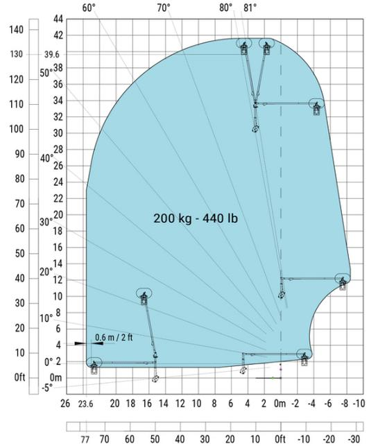
Machine sur stabilisateurs abaissés avec nacelle 3D négatif / Machine sur stabilisateurs abaissés avec 3D positif / négatif
