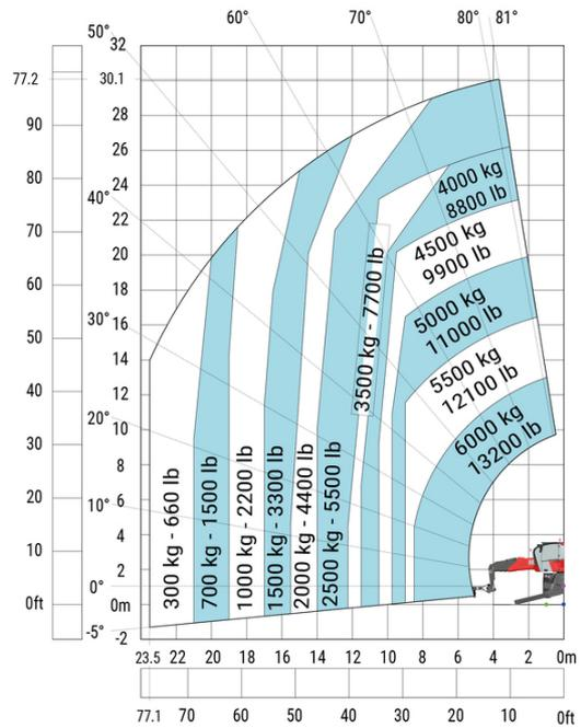
Machine sur stabilisateurs abaissés avec potence-treuil de 2000 kg (Métrique)
