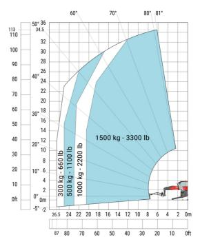
Maschine an abgesenkten Stabilisatoren mit Haken 9000 kg Drehung an abgesenkten Stützen mit 365 kg Arbeitskorb (Metrisch)
