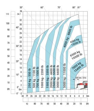
Maschine auf abgesenkten Stabilisatoren mit Winde 7200 kg Drehung an abgesenkten Stützen mit 1500 kg Ausleger (metrisch)
