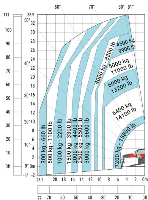
**Rotazione su stabilizzatori con braccetto jib da 1500 kg**
