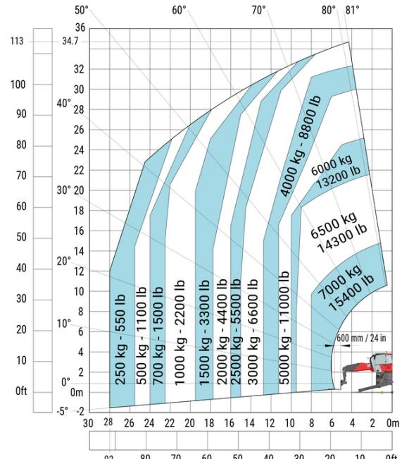
Macchina su stabilizzatori abbassati con argano 7200 kg
