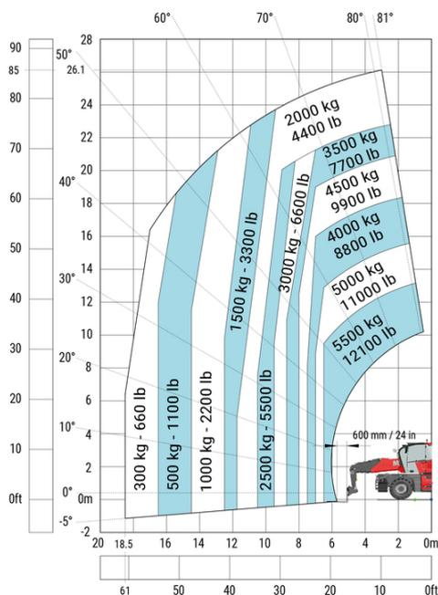
Drehung mit abgesenkten Stützen mit Gabeln
