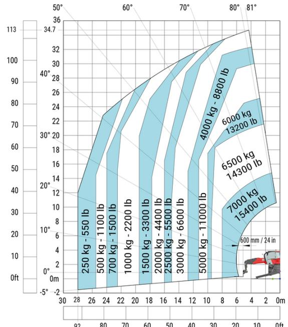
Machine on lowered stabilisers with winch 7200 kg (metric) Drehung an abgesenkten Stützen mit 1500 kg Ausleger
