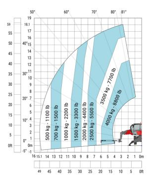
Máquina sobre estabilizadores rebajados con plumín de 1500 kg con cabrestante (sistema métrico)
