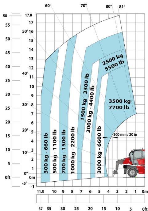
Машина при опущенных аутригерах с вилами - метрическая система мер
