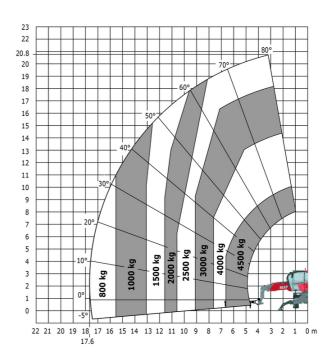
Rotación sobre estabilizadores bajados con plataforma de Rotación sobre estabilizadores bajados, con plataforma de 365 kg 1.000 kg
