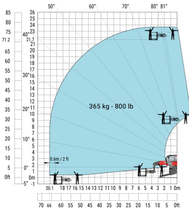
Machine sur stabilisateurs abaissés avec nacelle 1000 kg
