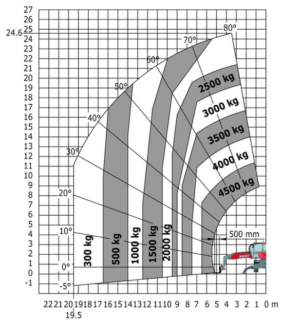
Машина при опущенных аутригерах с платформой 365 кг - метрическая система мер
