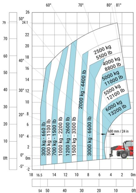
Rotación sobre estabilizadores bajados, con horquillas
