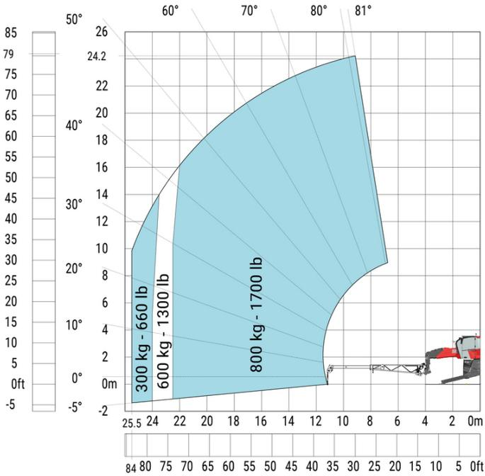
Máquina sobre estabilizadores bajados con gancho 9000 kg (Métrico)
