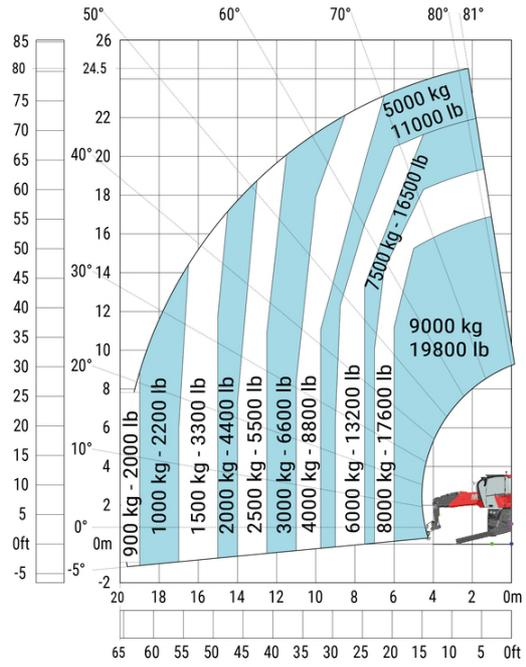
Rotación sobre estabilizadores bajados con plataforma de 365 kg
