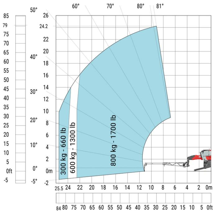
Machine sur stabilisateurs abaissés avec crochet 9000 kg (Métrique)
