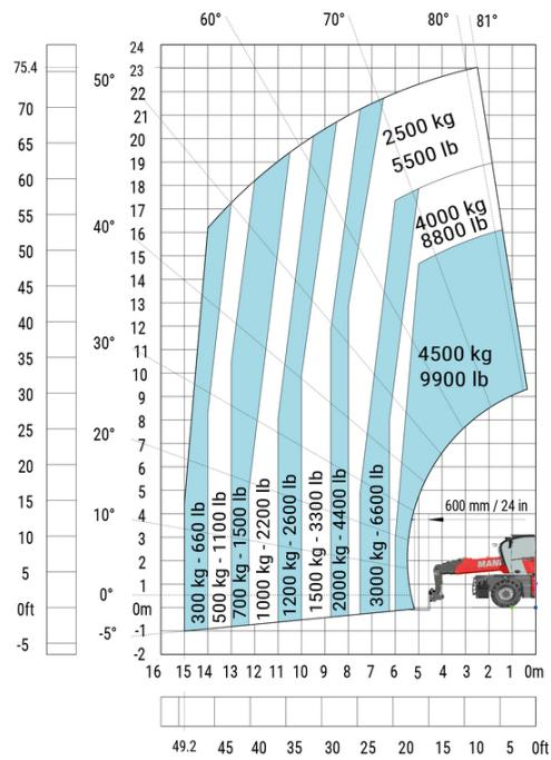
Máquina sobre estabilizadores rebajados con horquillas (CAF) Métrico
