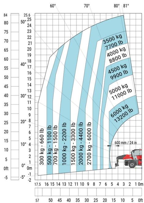
Машина на опущенных аутригерах с вилами (CAF), метрическая система мер
