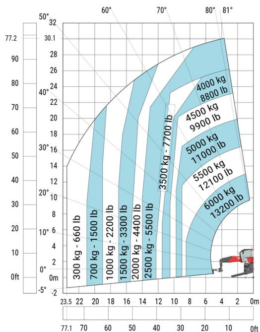
Машина на опущенных аутригерах с кран-балкой с лебедкой 2000кг, метрическая система мер
