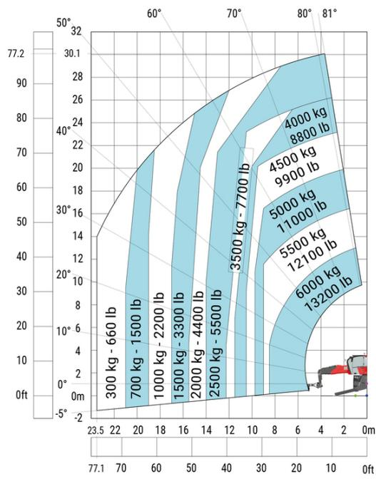
Машина при опущенных аутригерах с платформой 365 кг - метрическая система мер
