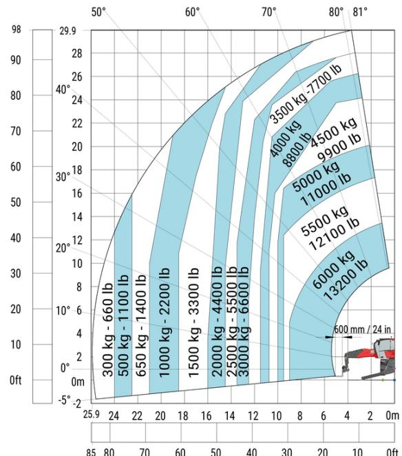
Машина на опущенных аутригерах с лебедкой 6000кг, Машина на установленных аутригерах с весом на стреле 2000 кг, метрическая система мер
