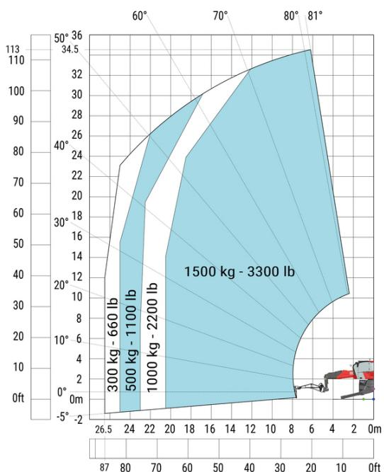
**Machine sur stabilisateurs abaissés avec crochet 9000 kg
