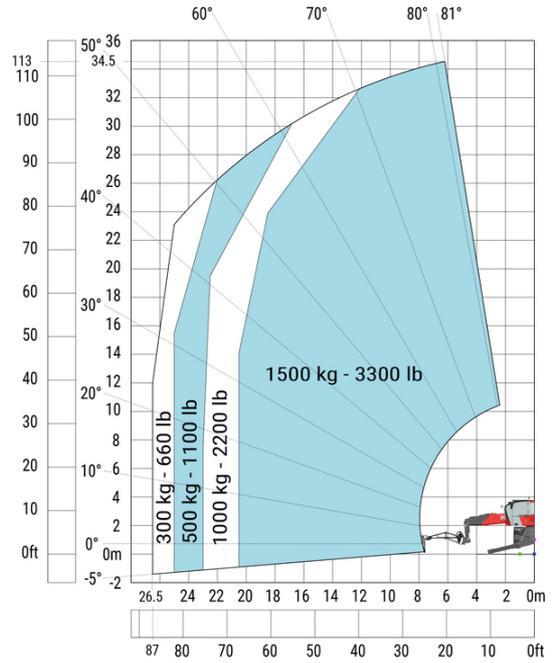
Машина на опущенных аутригерах с крюком 9000кг, метрическая система мер
