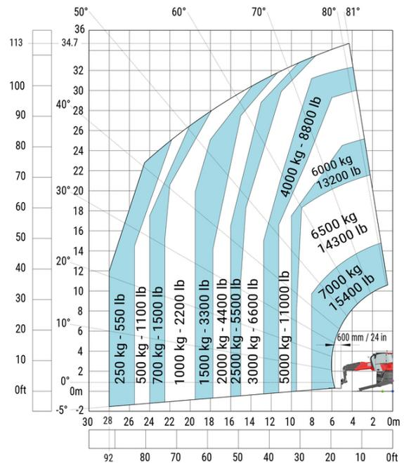
Машина на опущенных аутригерах с лебдкой 7200кг, Машина при опущенных аутригерах со стрелой 1500 кг - метрическая система мер
