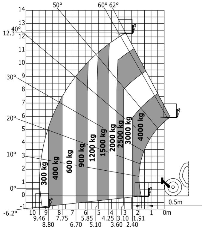
Rotación sobre estabilizadores bajados, con horquillas nivel
