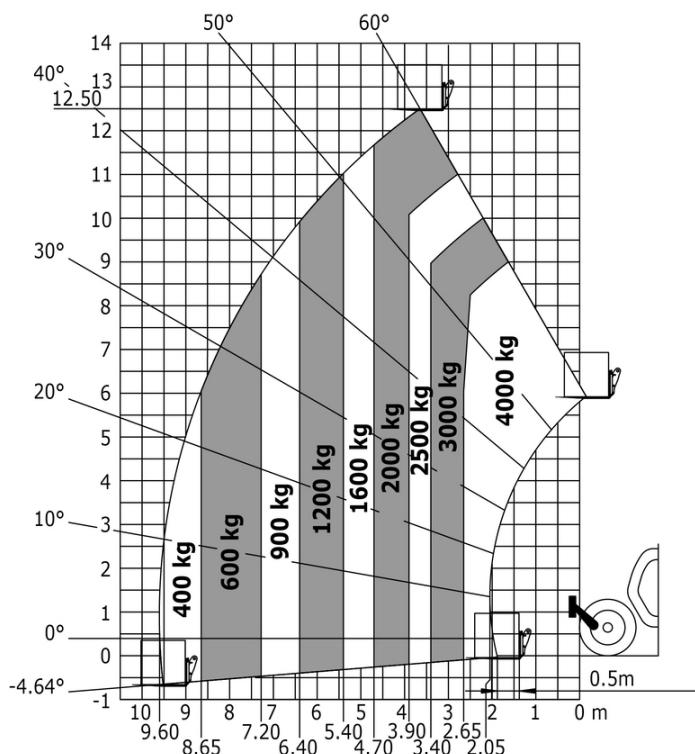
Rotación sobre estabilizadores bajados, con horquillas
