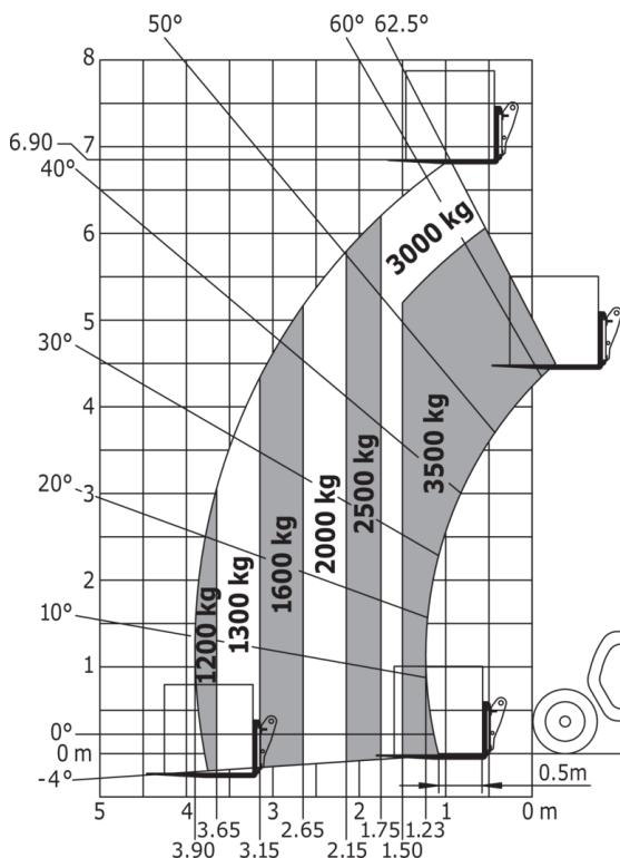
Машина на колесах с вилами LC 600 мм, метрическая система мер
