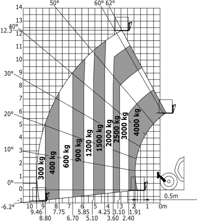
Maschine auf Rädern mit Gabelzinken - mit Niveaueausgleich
