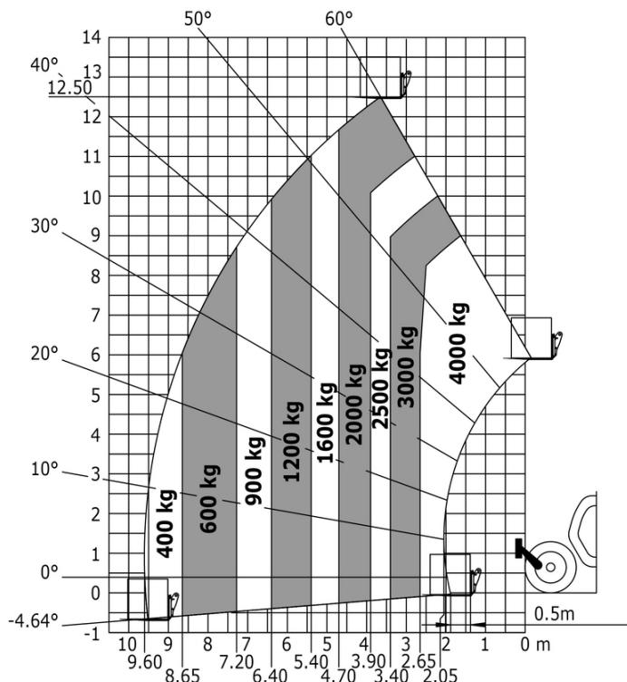
Machine sur stabilisateurs avec panier nacelle
