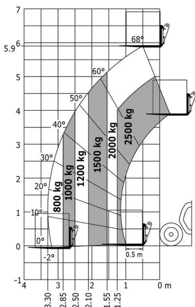
Maschine auf Rädern mit Gabelzinken LC 600 mm
