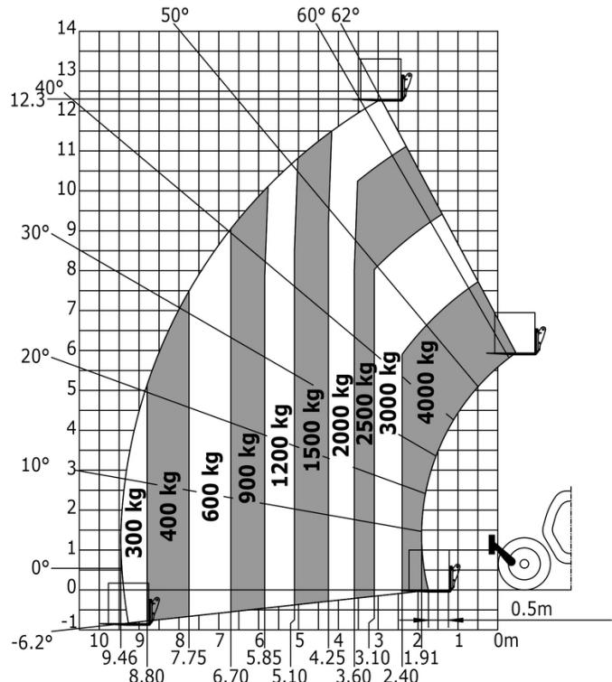
Máquina sobre estabilizadores rebaixados com garfos Metric
