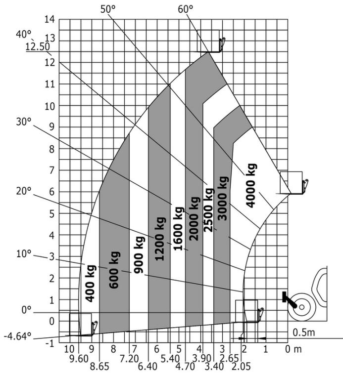
Drehung mit abgesenkten Stützen mit Gabeln
