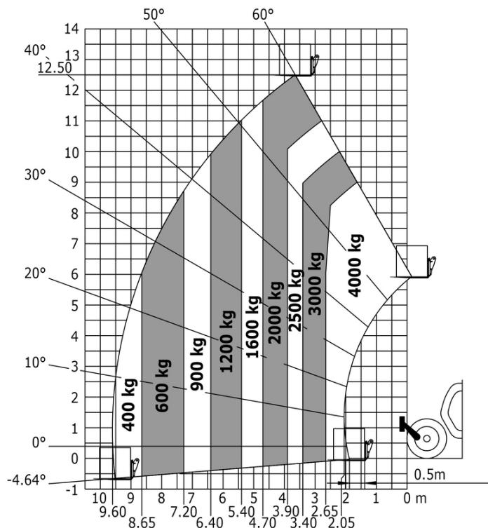
Drehung mit abgesenkten Stützen mit Gabeln
