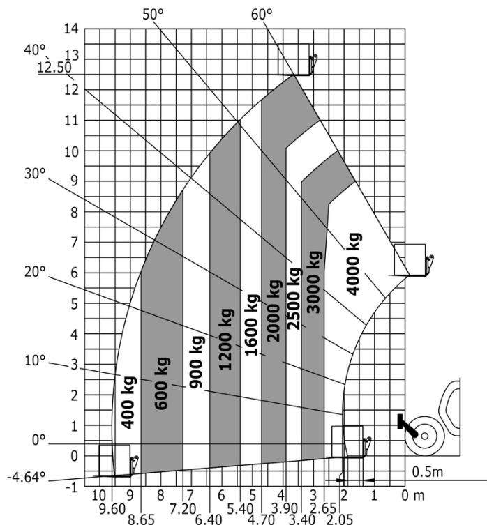
Drehung mit abgesenkten Stützen mit Gabeln
