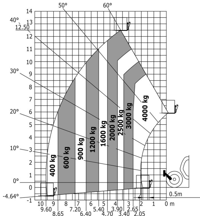
Drehung mit abgesenkten Stützen mit Gabeln
