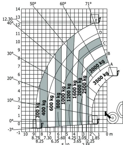
Máquina sobre estabilizadores rebaixados com garfos Metric
