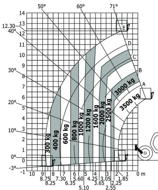
Drehung mit abgesenkten Stützen mit Gabeln
