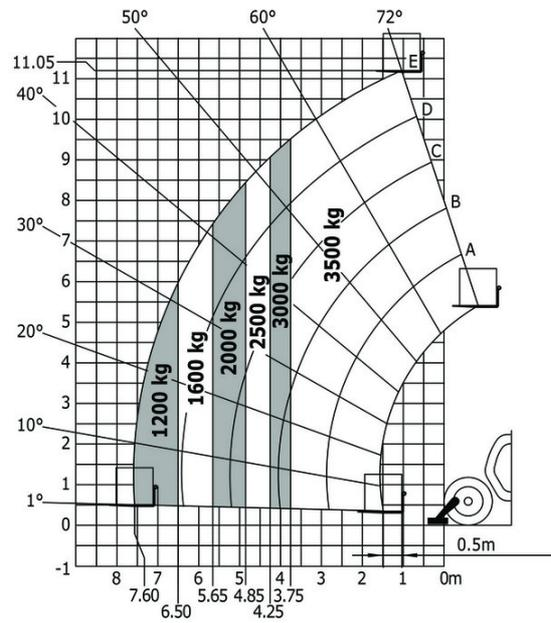
Máquina sobre estabilizadores con plataforma
