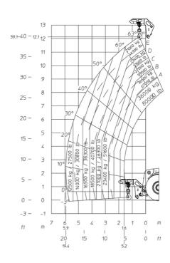
Máquina sobre neumáticos con pluma de ganchos 36000 kg (métrico)
