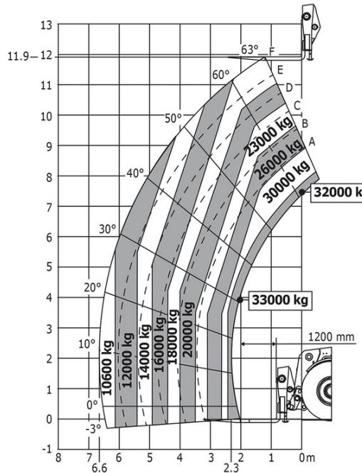
Macchina per pneumatici con braccio a gancio, capacità 36.000 kg (metrica)
