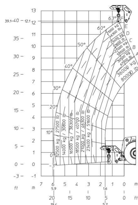
Máquina sobre pneus com lança de ganchos 36000 kg
