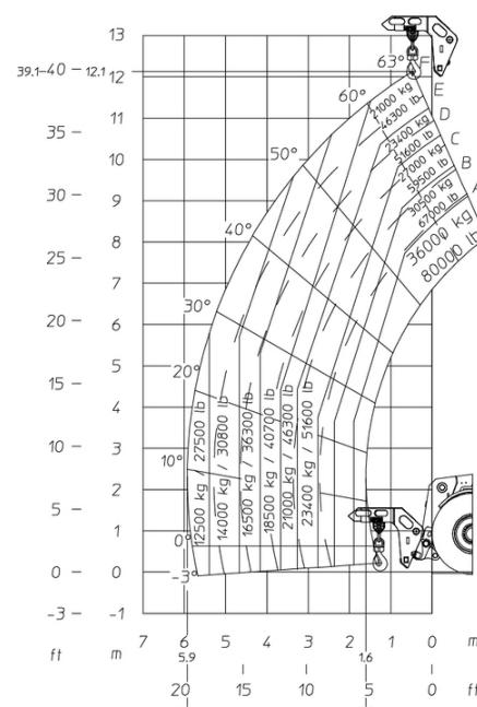
Máquina sobre neumáticos con pluma de ganchos 36000 kg (métrico)
