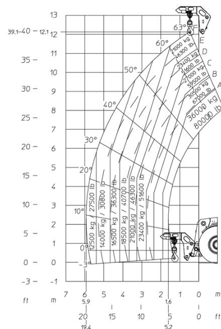
Машина на колесах с краном с 3-мя крюками 36000кг, метрическая система мер
