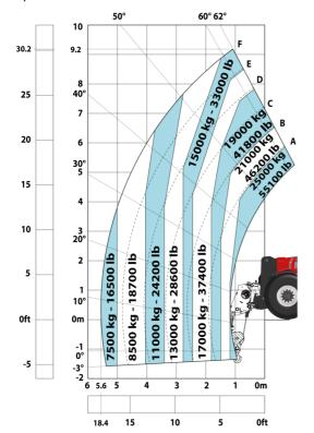
Máquina sobre neumáticos con horquillas LC 1200 mm
