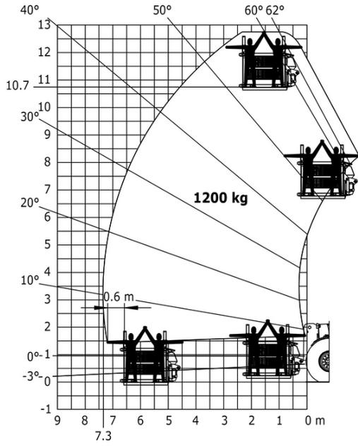
Máquina sobre neumáticos con manipulador de neumáticos TH 63 (métrico)
