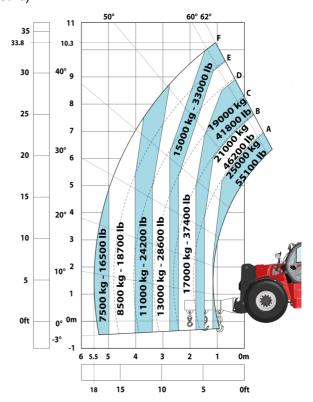
Machine sur pneus avec panier mine (Métric)
