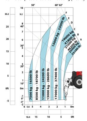
Machine sur pneus avec potence 3 crochets 25000 kg (Metric)
