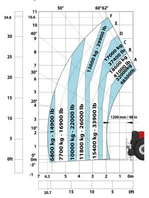
Machine sur pneus avec treuil 25000 kg (Metric)
