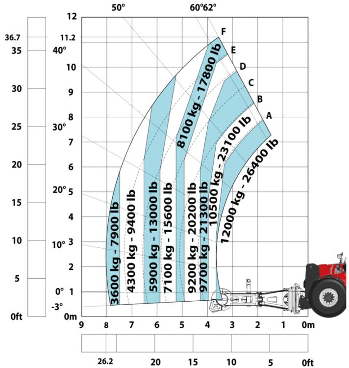
Машина на колесах с захватом для цилиндров СН 10, метрическая система мер
