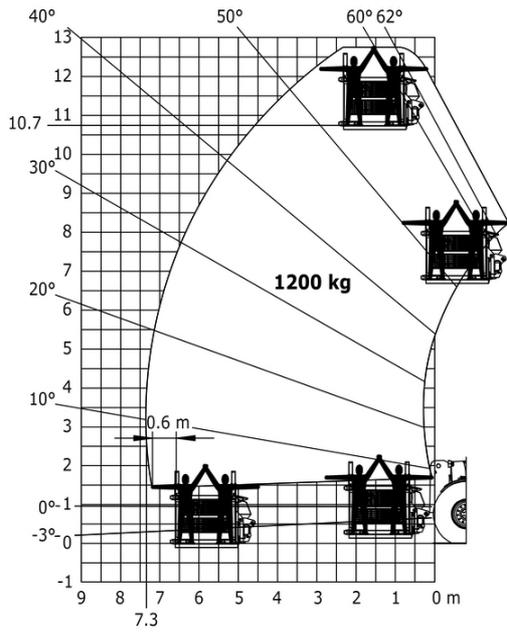
Машина на колесах с захватом для шин ТН 63, метрическая система мер
