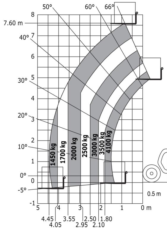
Maschine auf Rädern mit Gabelzinken LC 600 mm
