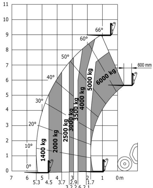
Máquina sobre neumáticos con horquillas LC 600 mm
