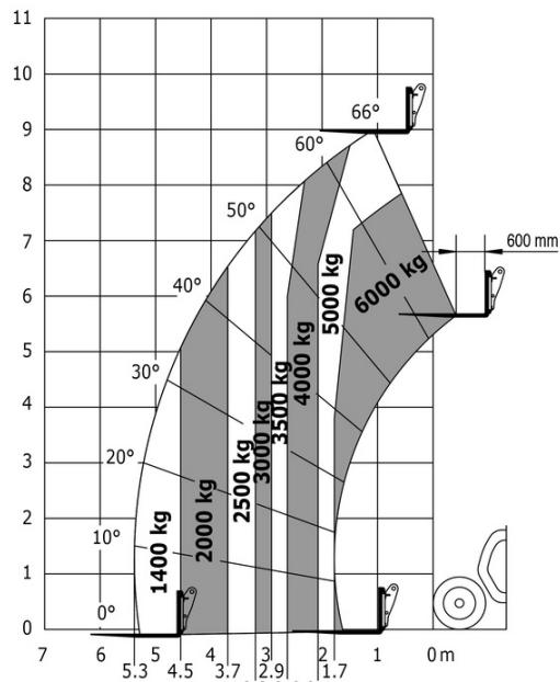
Машина на колесах с вилами LC 600 мм, метрическая система мер
