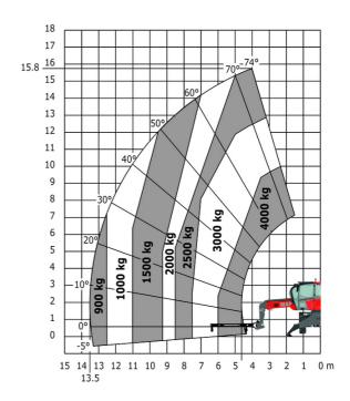
Maschine auf abgesenkten Stabilisatoren mit 1500 kg WindeMaschine auf abgesenkten Stabilisatoren mit Haken 5000 (Metrisch) kg (Metrisch)
