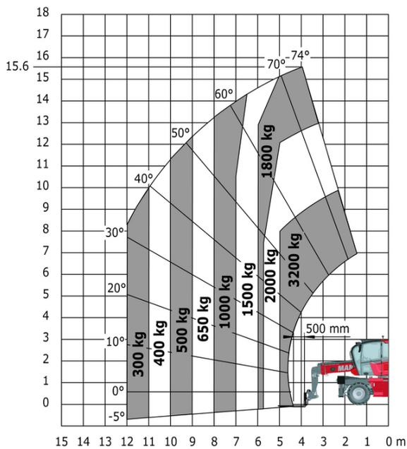
Rotación sobre estabilizadores bajados, con horquillas
