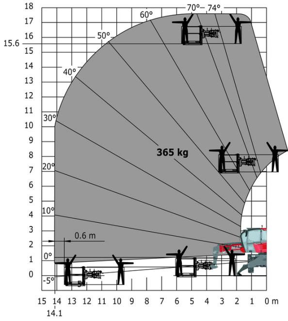
Rotación sobre estabilizadores bajados, con plataforma de 1.000 kg
