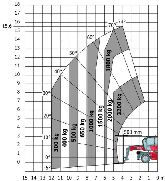
Drehung auf abgesenkten Stützen mit Gabeln
